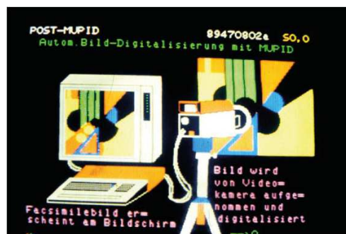
Abb. 5: Mit MUPID und Videokamera war eine direkte Bildabspeicherung möglich.
