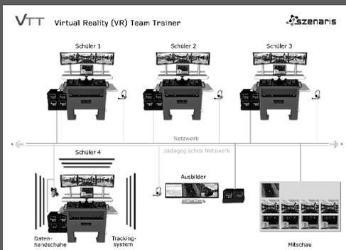
Abbildung 2: Systemübersicht eines virtuellen Teamtrainingsystems
